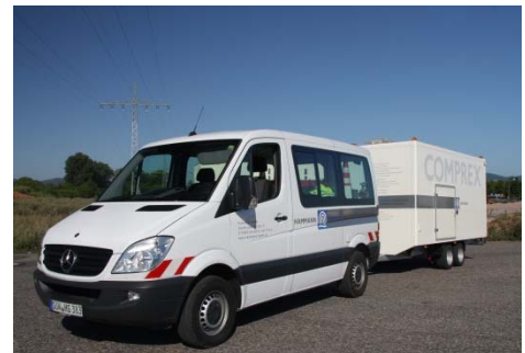
Abbildung 1: Complex ® -Einheit zur Bereitstellung von Druckluft
