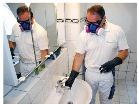
Abbildung 3: Prüfen der ClO 2 -Konzentration während der Desinfektion
