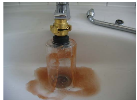
Abbildung 3: Trübung bei Ausspeisung über Waschbecken
