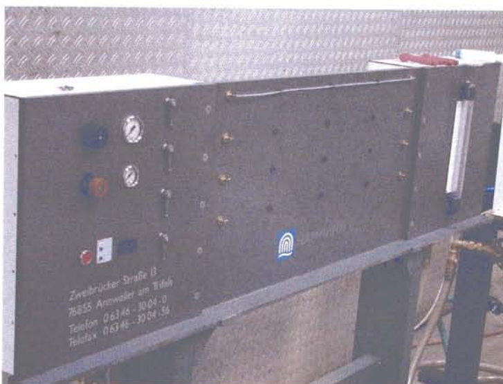
Abbildung 2: Teststand zur Reinigung von Endoskopschläuchen mittels Comprex-Verfahren.
