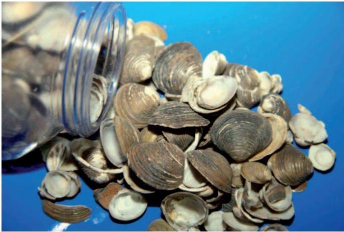
Bild 8: Mittels Complex®-Verfahren aus Flusswasserleitungen entfernte Muschelschalen
