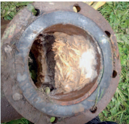
BILD 1: Kalkablagerungen aus einer Kunststoff-Rohrleitung DN 150 nach Complex-Reinigung: ausgebauter Flanschbogen (links); entfernte Kalkablagerungen (Mitte); Größenvergleich (rechts)
