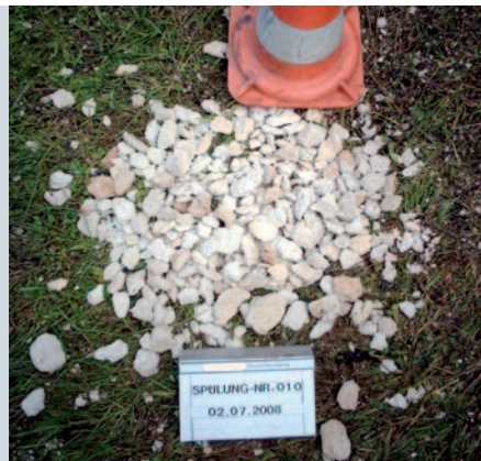
BILD 1: Kalkablagerungen aus einer Kunststoff-Rohrleitung DN 150 nach Complex-Reinigung: ausgebauter Flanschbogen (links); entfernte Kalkablagerungen (Mitte); Größenvergleich (rechts)
