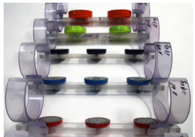
Bild 2: Haltevorrichtung mit Magneten unterschiedlicher Kraft
