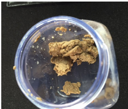
Bild 4: Aus dem Kühlsystem ausgetragene Ablagerungen (Beispiel 1)
