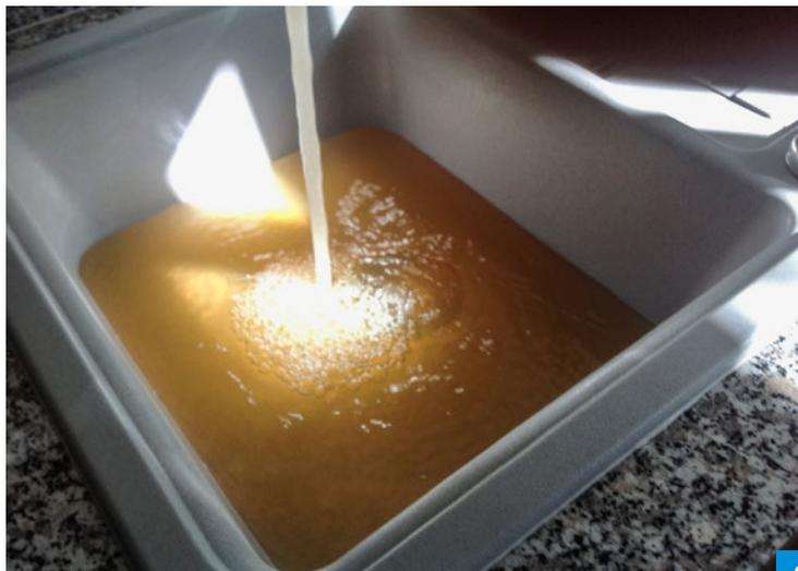
Korrosion in Leitungen aus schmelztauchverzinkten Stahlleitungen führt oft nach thermischen Desinfektionen zu erheblicher Braunfärbung des Trinkwassers.
