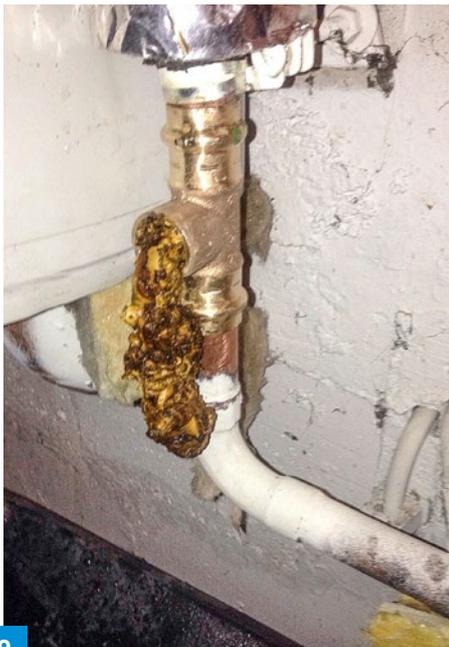
9 Austrag einer abgelösten Epoxidharz-Schicht aus einer Trinkwasser-Installation: Die vollständige Neuinstallation des Leitungssystems ist hier alternativlos.
