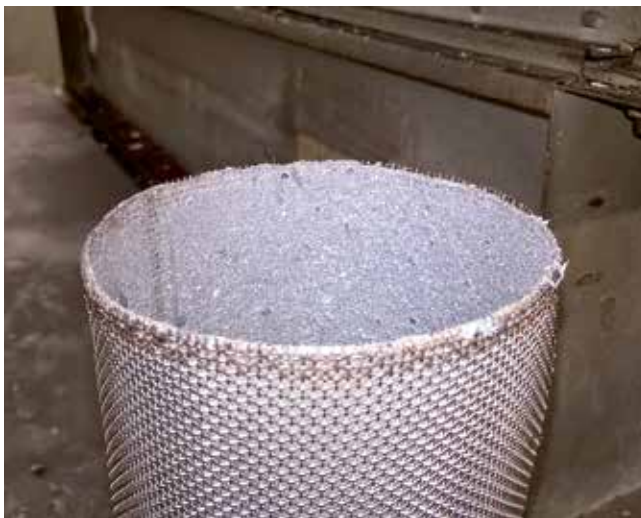
1 Durch Partikel aus Emulsionsleitungen verblocktes 100- \mu\text{m} -Sieb einer Bearbeitungsmaschine und durch Comprex-Reinigung ausgetragene Ablagerungspartikel (© Hammann)
