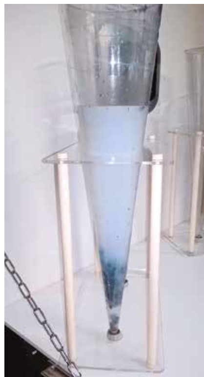
5 Im Spülwasser werden das Absetzverhalten und der Gehalt an Partikeln per Imhoff-Trichter bestimmt (© Hammann)
