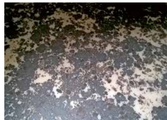
4 Aus der Emulsionsleitung ausgespülte Partikel werden aufgefangen und für weitere Analysen in ein Labor geschickt (© Hammann)
