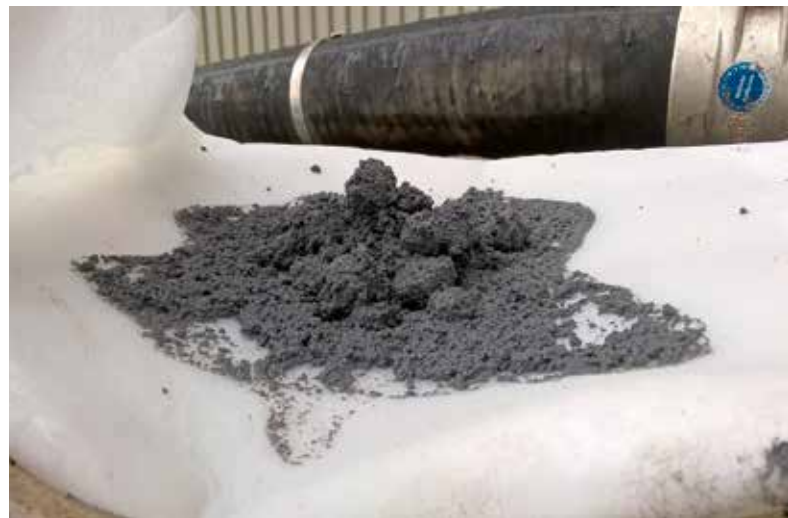
1 Durch Partikel aus Emulsionsleitungen verblocktes 100- \mu\text{m} -Sieb einer Bearbeitungsmaschine und durch Comprex-Reinigung ausgetragene Ablagerungspartikel (© Hammann)
