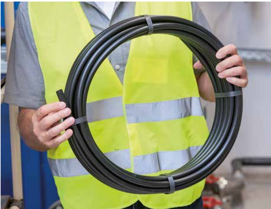
Zielprodukt der neu installierten Extrusionsanlage sind unterschiedlich dimensionierte Schläuche für Bewässerungssysteme.
