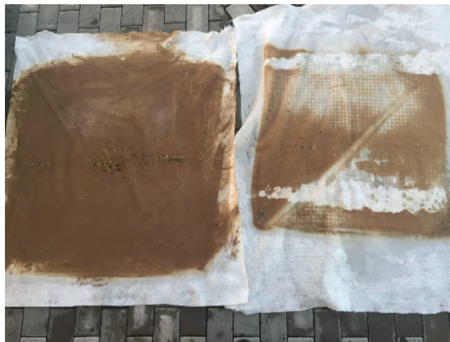
Bild 4. Zwei mit ausgetragenen Partikeln beladene Filtervliese. Diese können bedenkenlos entsorgt werden © Hammann
