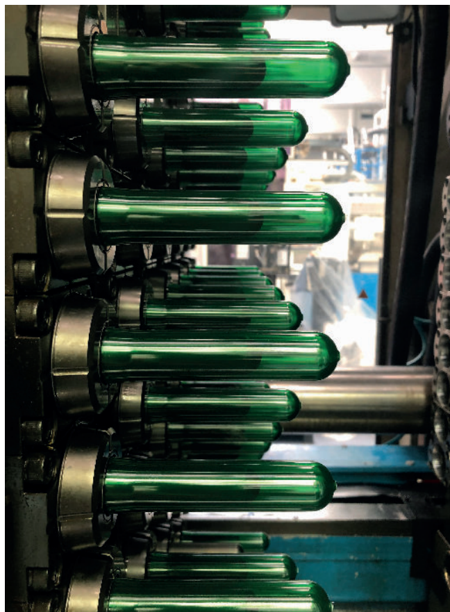
Multi-Kavitäten-Werkzeug zur Herstellung von Preforms für PET-Flaschen
