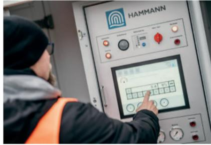
**Bild 3 Einstellen der Reinigungsparameter am Complex-Anhänger**
