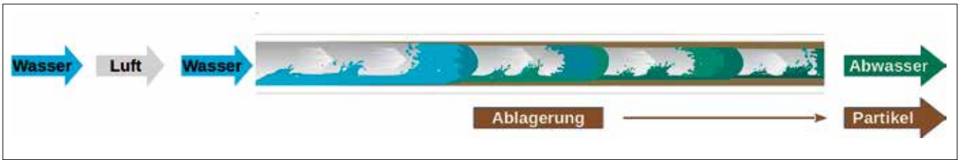
Wirkungsweise der Complex-Reinigung: Abwechselnde Blöcke von Wasser und Luft tragen Verunreinigungen und Ablagerungen aus.
