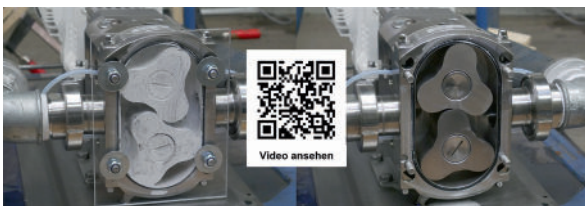
Abb. 9 // Pumpe mit durchsichtigem Kunststoffdeckel für die Versuche nach Applikation der Dispersionsfarbe (links) und nach Reinigung (rechts). Der QR-Code führt zum entsprechenden Video der Pumpenreinigung in Echtzeit.
