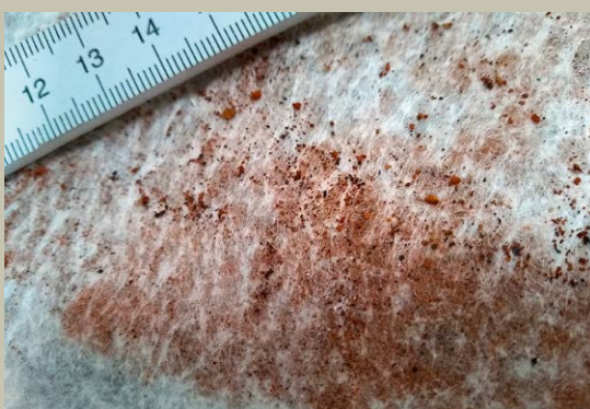
Bild 5: Ausgetragene Feststoffe aus Spritzgießwerkzeug auf Filtervlies
