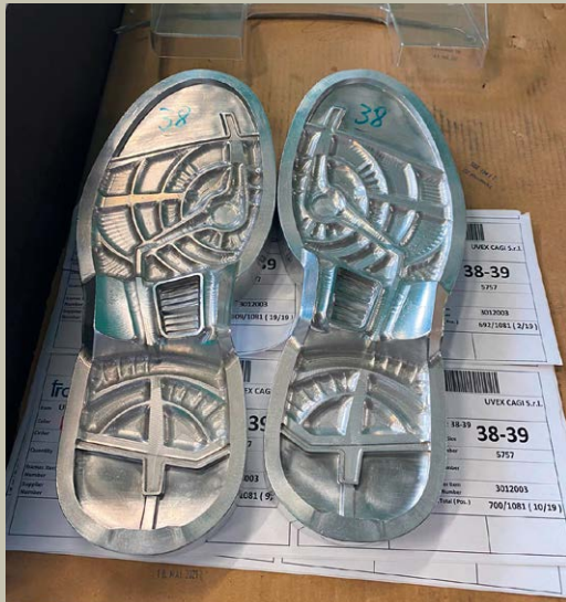
Bild 4: Beispiel für Spritzgießwerkzeug und Werkzeugeinsatz für Schuhsohle
