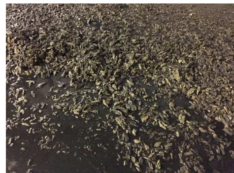
Abbildung 4: Ausspeisung der Ablagerungen in Pumpensumpf
