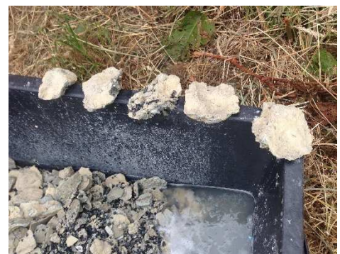
Abbildung 4: Austrag von bis zu 8 cm großen Stücken
