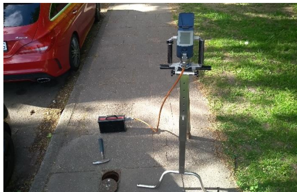
Abbildung 1: Schieberdrehgerät im Einsatz
