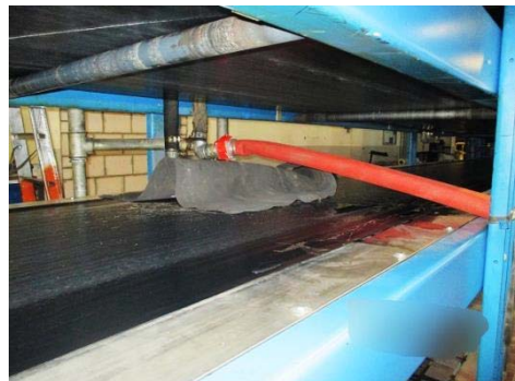
Abbildung 4: Zugang zum System über Adapteranschlüsse (Ausspeisung)
