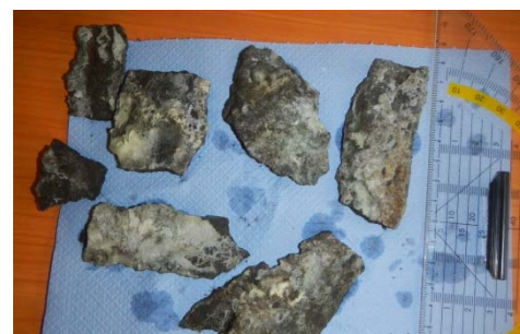
Abbildung 5: aus dem System entfernte Verkrustungen
