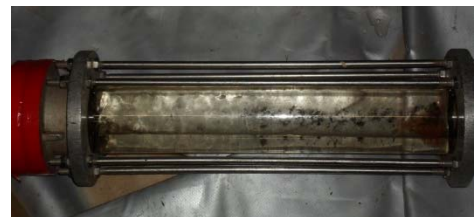
Abbildung 4: Grobpartikel in Schauglas
