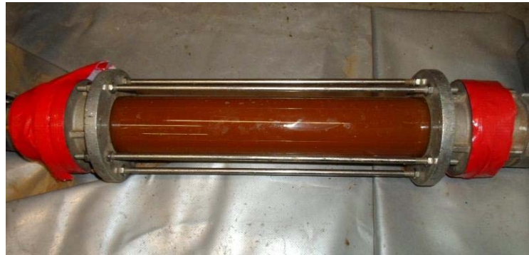
Abbildung 1: Trübung in Schauglas
