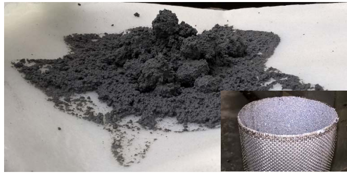
Abb. 1: Ablagerungen aus KSS-System
