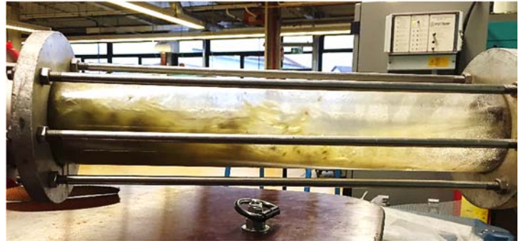
Abbildung 1: Trübung in Schauglas während der Reinigung
