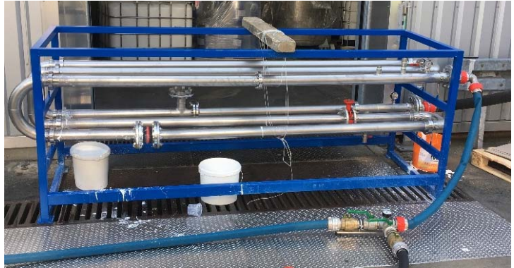
Abbildung 1: Teststrecke mit Rohrleitungssystem für Lacke
