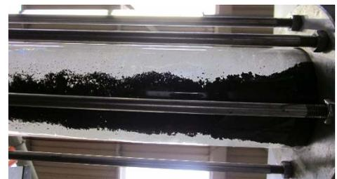
Abbildung 4: Grobpartikel in Schauglas am Ende der Reinigung
