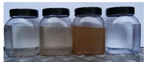
Abbildung 5: Trübung des Spülwassers im Verlauf der Reinigung
