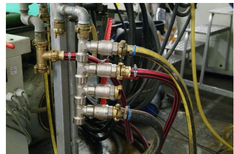
Abbildung 3: Anschluss über Adapteranschlüsse und Verteiler
