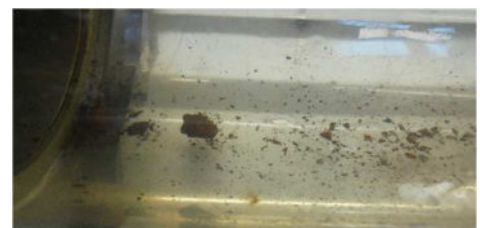
Abbildung 5: ausgetragene Grobpartikel in Schauglas während der Reinigung
