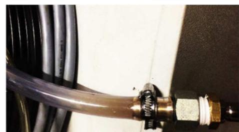
Abbildung 2: Trübung in Schlauchleitung während der Reinigung
