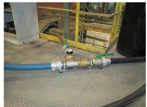
Abbildung 3: Einspeisung von Druckluft und Wasser über Adapteranschlüsse
