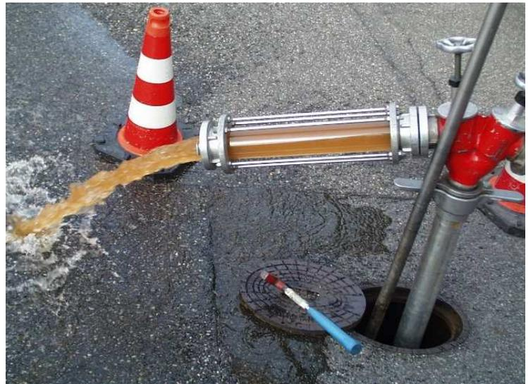
Abbildung 1: Funktionsprüfung an Hydrant
