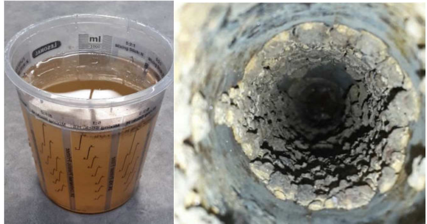
Abbildung 1: Durchflusstrübung (links) und Ablagerungen (rechts)
