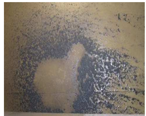
Abbildung 4: ausgetragene Späne und Partikel in Container
