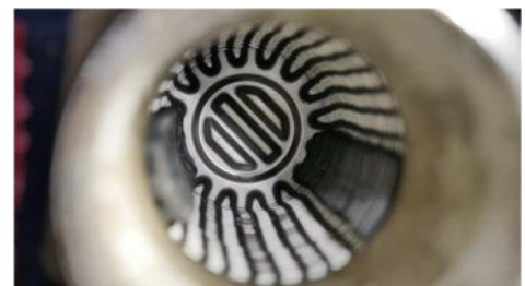
Abbildung 5: Gereinigter Zustand der Produktseite
