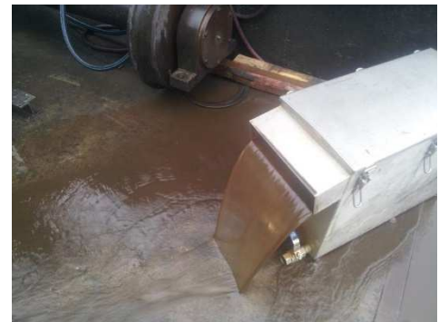
Abbildung 2: Trübung an Auslaufbox während der Reinigung
