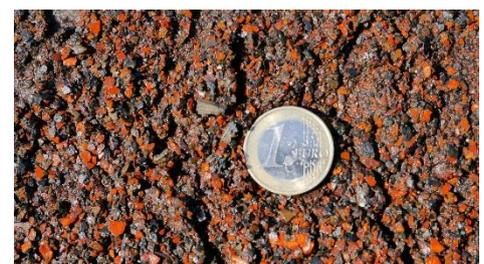
Abbildung 5: ausgetragene Verunreinigungen aus Rohrbündelwärmetauscher
