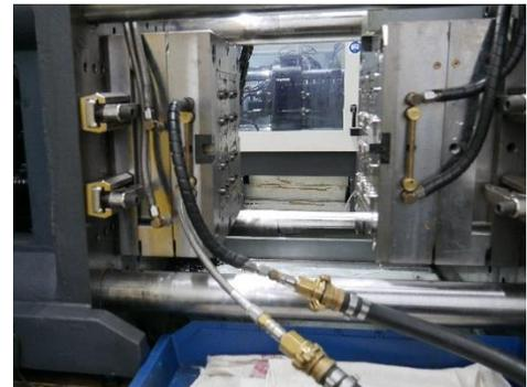
Abbildung 2: Zugang zum Werkzeug über standardisierte Adapteranschlüsse
