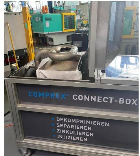
Abbildung 6: Connect-Box zum Realisieren der Kreislaufführung
