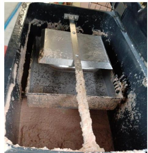
Abbildung 8: Schaumbildung während der Reinigung in Dekomprimierbox
