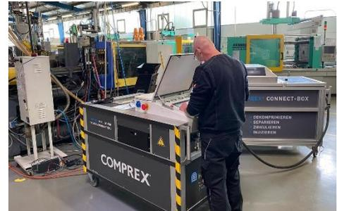
Abbildung 3: Reinigen mittels MCU-300
