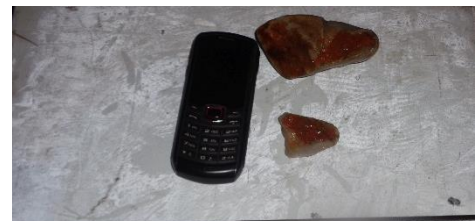
Abbildung 5: aus Rohrleitung ausgetragene Grobpartikel
