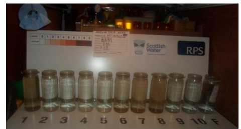
Abbildung 4: Trübungsmessung im Verlauf der Reinigung
