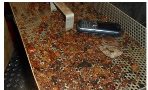
Abbildung 5: aus Rohrleitung ausgetragene Grobpartikel
