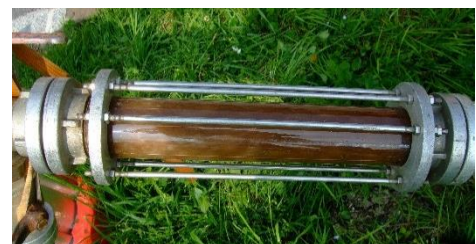
Abbildung 4: Schauglas während der Reinigung
