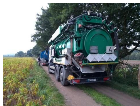
Abbildung 3: Saugwagen zur Abwasserentsorgung
