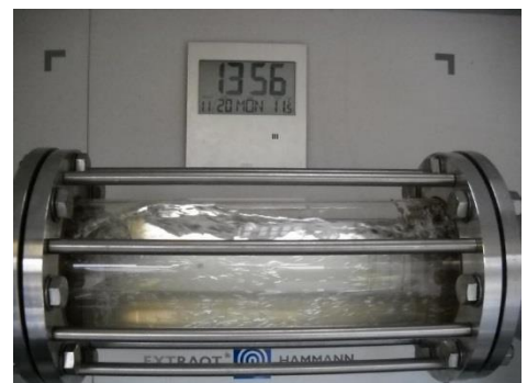
Abbildung 4: nachlassende Trübung am Ende der ExtraQt®-Spülung
