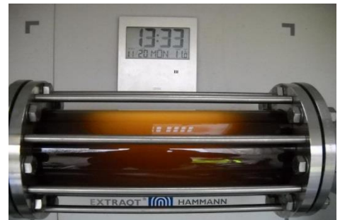
Abbildung 3: Trübung in Schauglas während der ExtraQt®-Spülung
