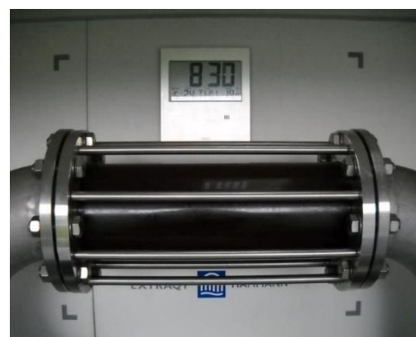
Abbildung 3: Trübung in Schauglas während des ExtraQt®-Prozesses
