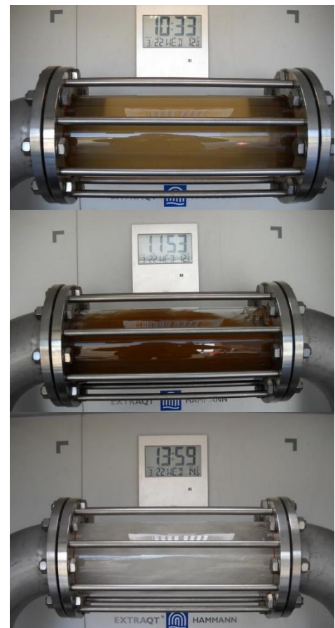
Abbildung 3: zeitlicher Verlauf der Trübung während der ExtraQt®-Spülung
