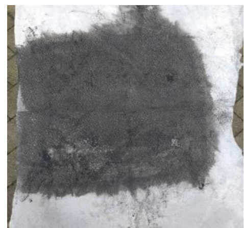
Abbildung 7: Feststoffaustrag aus Extruder auf Filtervlies
