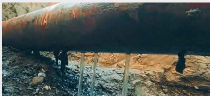
Fig. 5 Pipe perforations due to abrasion of coarse particles in the base area [4] Perforation de tuyau suite à l'abrasion par des particules grossières dans le fond [4]
