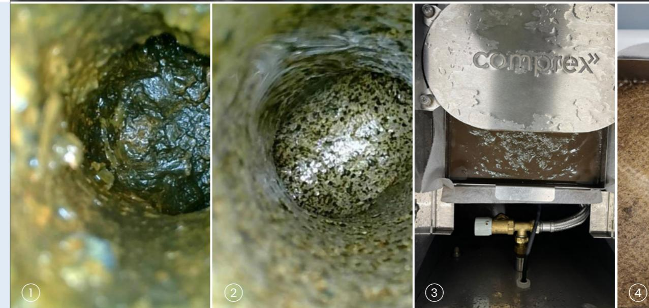
Hier wird sichtbar, wie effektiv Pulse100·ToolClean Kühl- und Temperierkreisläufe von Ablagerungen befreit.
