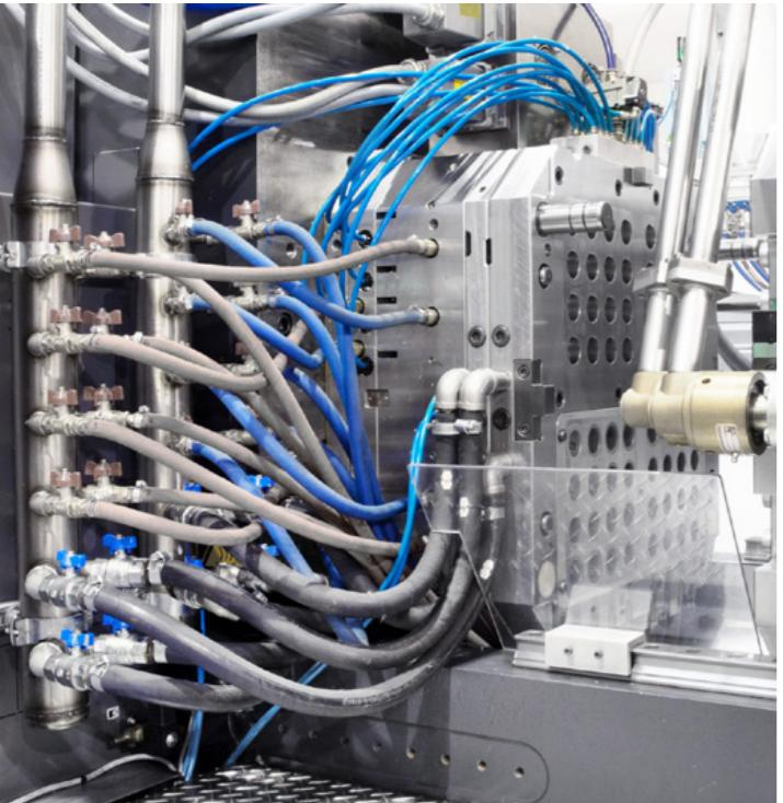
Mit dem patentierten Comprex® Reinigungsverfahren entfernt Pulse100·ToolClean selbst hartnäckige Ablagerungen und Verunreinigungen direkt aus den Kreisläufen – ohne aufwendige Demontage und bei minimalen Produktionsunterbrechungen.
