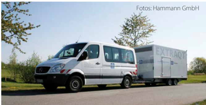
Bild 1: ExtraQt-Einheit zur Wasser-Saug-Spülung und hydraulisch unterstützter Zustandserfassung
